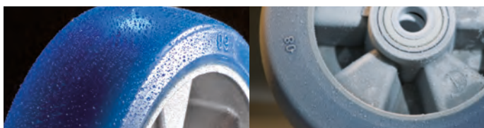
Primjer: provjera otpornosti na upijanje vode
