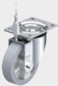
Okretni sklop kotača sa kočnicom smjera na povlačenje kabela
